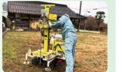
機械で地面に鉄の棒を突き刺しながら地盤を調査していました
